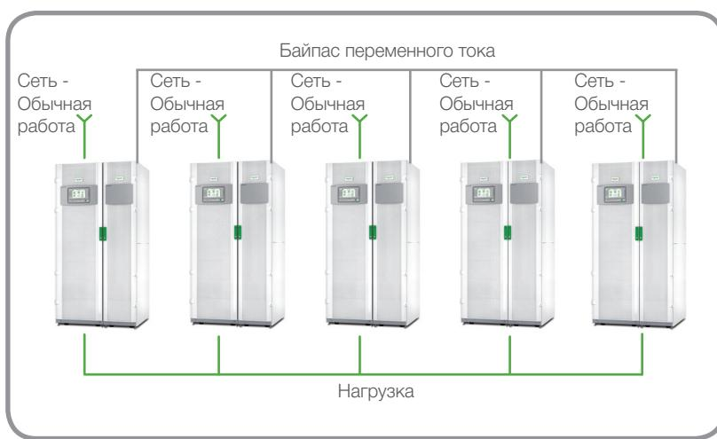
Распределенное параллельное соединение для резервирования и увеличения мощности
