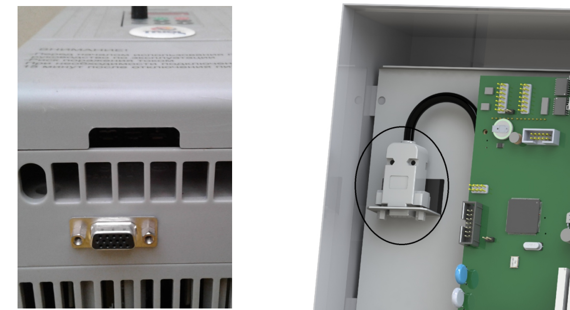
Рисунок 2.19 — Расположение разъёма для подключения энкодера: 5K5...7K5 — слева, 11K...37K — справа
