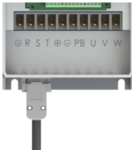
Рисунок 2.11 — Подключение кабеля энкодера , типоразмер (5K5-7K5)
