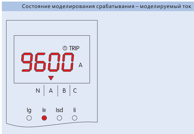
Состояние моделирования срабатывания – моделируемый ток
