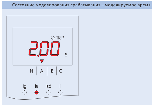
Состояние моделирования срабатывания – моделируемое время
